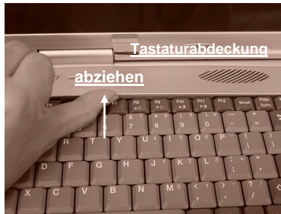
Bild 1 Entfernen der Tastaturabdeckung
